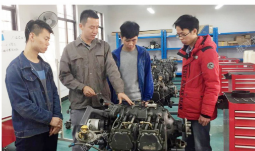
莱康明活塞式航空发动机维修实训
